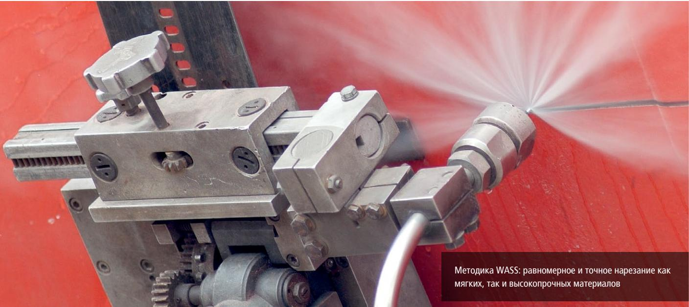
Методика WASS: равномерное и точное нарезание как мягких, так и высокопрочных материалов
